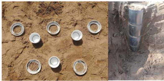
图1 微型蒸发器布设及环刀法
